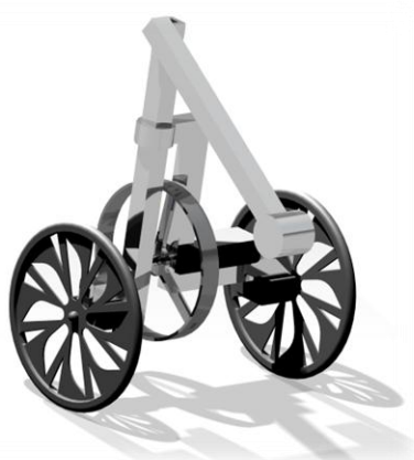
شکل ۱ طرح سه بعدی ربات دو چرخ بازودار به همراه چرخ عکس‌عملی
