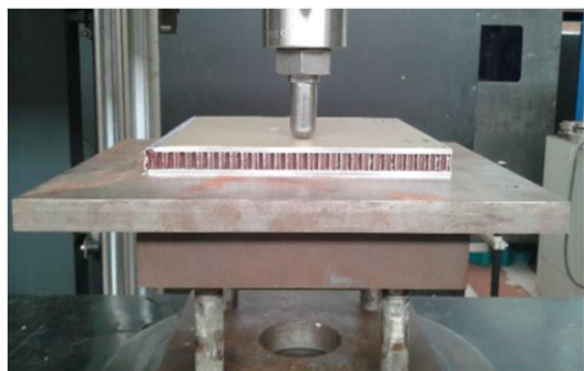
شکل 3 ورق ساندویچی با تکیه‌گاه صلب تحت بارگذاری استاتیکی
