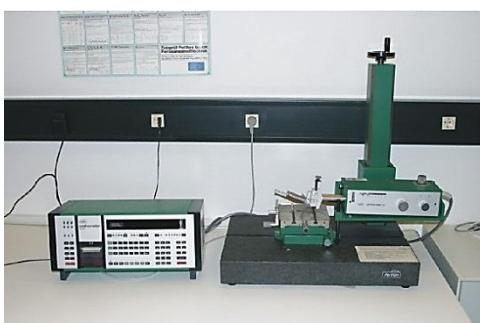
شکل 2 دستگاه سنجش صافی سطح مورد استفاده
