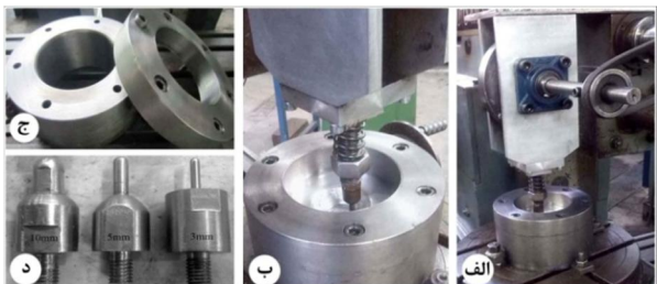
شکل 2 نمایی از فرایند کار تجربی، الف) ابزار ضربه زننده، ب) کلمپ ورق و نمونه فرم یافته، ج) سیستم کلمپ، د) قطرهای مختلف پانچ.
