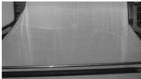
شکل 6 اعمال عیب چهار سوزن شکسته در پارچه
