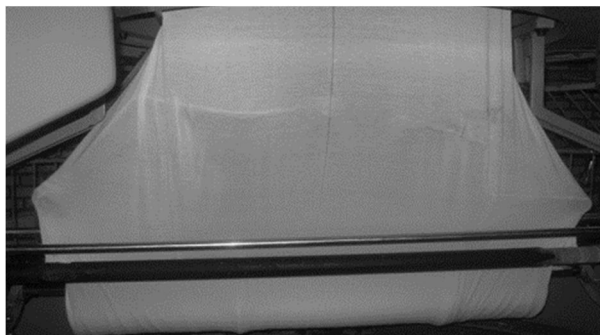
شکل 5 اعمال عیب دو سوزن شکسته در پارچه
