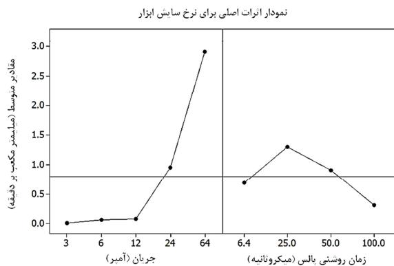
شکل ۹ نمودار اثرات اصلی پارامترهای ورودی بر روی مقادیر نرخ سایش ابزار
