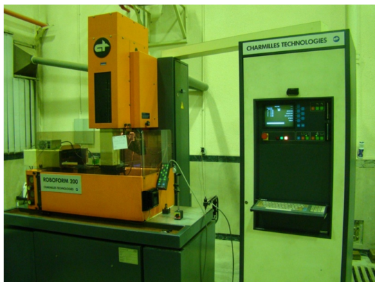
شکل ۴ دستگاه اسپارک مورد استفاده در آزمایشات
