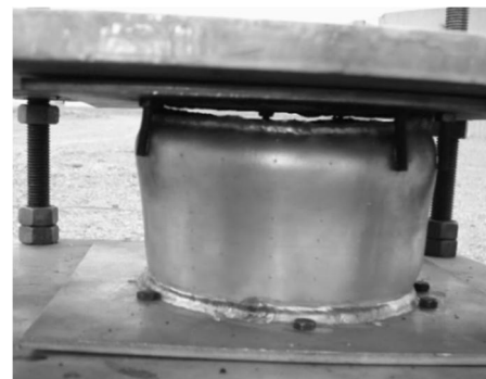
شکل 17 پارگی در محل اتصال ورق به پوسته
