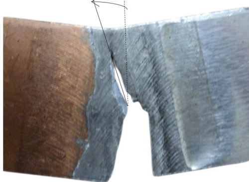
شکل 4 زاویه انتشار ترک در نمونه جوشکاری شده تحت آزمایش خمش چهار نقطه‌ای ( n=80\% )
