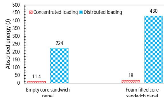
شکل 12 مقایسه نمودارهای مربوط به انرژی جذب شده مربوط به هر دو ساندویچ پنل تحت بارگذاری‌های متمرکز و گستردگی
