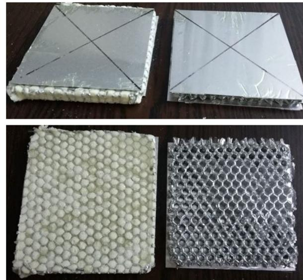
**شکل 6** ساندویچ پنل‌های خالی و پر شده با فوم تحت بارگذاری گستردگی (به ترتیب از بالا: سازه‌ای ساندویچی و شکل‌های پایینی ساندویچ پنل‌ها بدون رویه بالایی)
