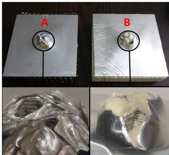
شکل ۵ تصویر پشت نمونه‌ها بعد از نفوذ شبیه استاتیک (A). ساندویچ پنل با هسته لانه زنبوری خالی. B. ساندویچ پنل با هسته لانه زنبوری پر شده از فوم
