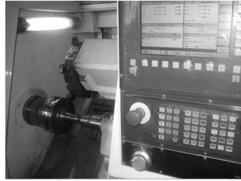
شکل ۲ ماشین تراش CNC Siemens 810 D در حین ماشین کاری یک قالب نورد
