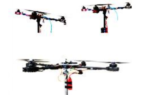
Fig. 14 Simulation model for quadrotor with three degree of freedom شکل 14 ساختار مدل شبیه‌ساز سه درجه آزادی
