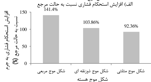
شکل 8 افزایش استحکام فشاری و استحکام فشاری به جرم نسبت به حالت مرجع
