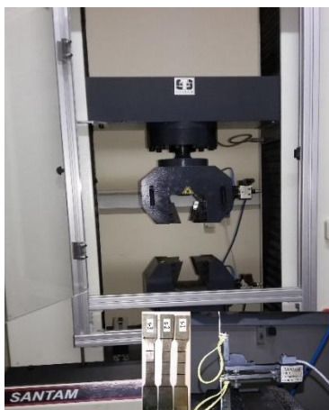
Fig. 7 Steel sheet tensile test
