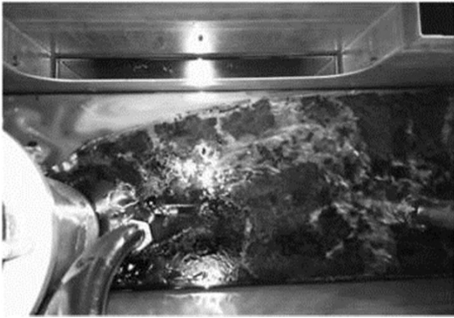
شکل 1 پسماند ایجاد شده در مرور زمان در مخزن سیال برشی دستگاه سنگزنی
