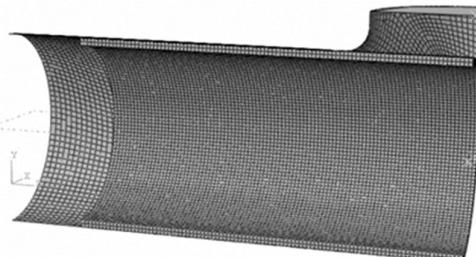
شکل 10 نمایی از مدل شبیه سازی قالب صلب به صورت یک چهارم
