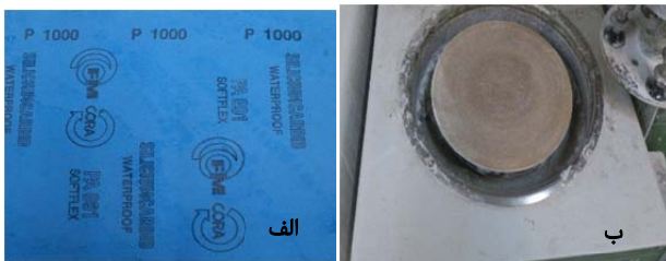
شکل ۳ دستگاه صیقلی و صفحه سیلیکون کاربرد؛ الف) صفحه سیلیکون کاربرد، ب) دستگاه صیقلی
