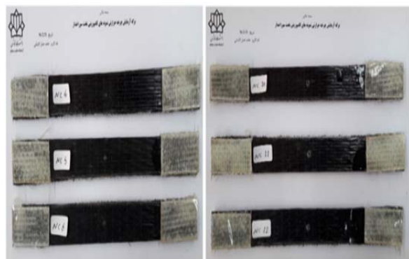
شکل ۲) نمونه‌های سوراخ‌کاری شده با قطرهای ۲ و ۴ میلی‌متر
