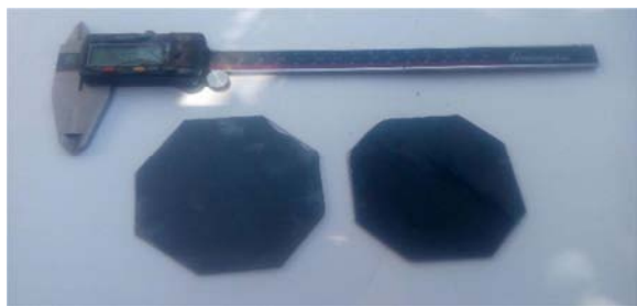
Fig. 12 Initial blank for experiments with two drawing ratio شکل 12 لوح اولیه برای انجام آزمایش عملی دو نسبت کشش متفاوت
