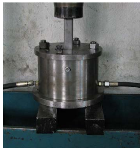
Fig. 11 Hydromechanical deep drawing equipment شکل 11 دستگاه کشش عمیق هیدرومکانیکی
