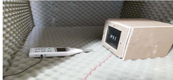
شکل ۴) چیده‌مان آزمون برای لاستیک طبیعی تک‌لایه همراه با الیاف پلی‌استر
