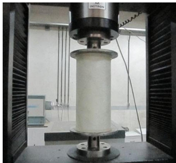
شکل ۷ پوسته مشبک نانوکامپوزیتی تحت بار محوری فشاری
