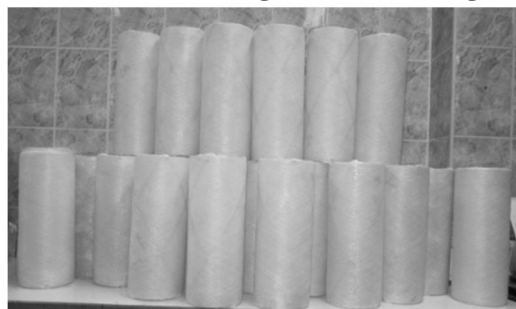
شکل 1 پوسته‌های مشبک نانوکامپوزیتی تولید شده به روش پیچش لایف
