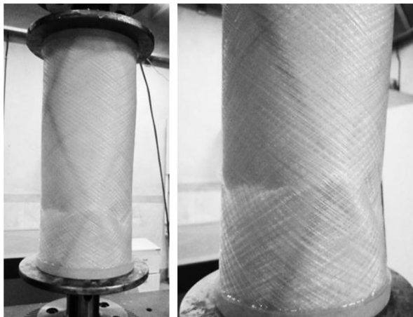
شکل ۸ پوسته‌های مشبک نانوکامپوزیتی پس از کمانش.
