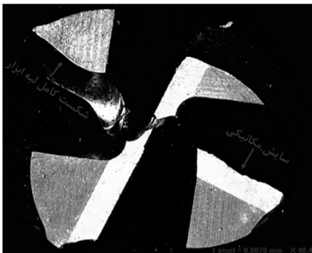
شکل ۴ تصویر لبه ابزار استفاده‌شده در فرزکاری پروفایل
