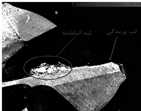
شکل ۳ تصویر لبه ابزار استفاده‌شده در فرزکاری ماریچج
