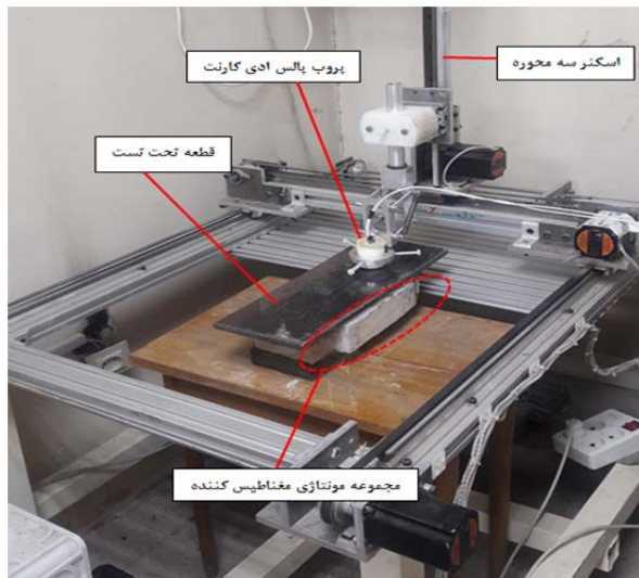
شکل ۶ تصویر مجموعه آزمایشگاهی برای انجام آزمون پالس ادی‌کارنت روی قطعه مورد آزمون
