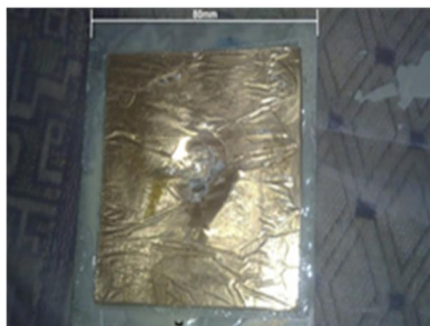
شکل 7 عدم ایجاد جدایش و تورق در نمونه دارای وصله نوع 1 بعد از ضربه
