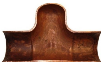
شکل 15 قطعہ سه‌راهی T شکل آزمایش هیدروفرمینگ پالسی
