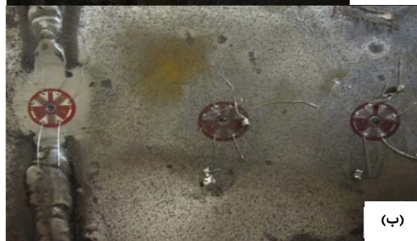
شکل (۲) آزمایش کرنش‌سنجی سوراخ؛ (الف) سطح خارجی (ب) سطح داخلی
