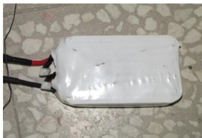
شکل 8 باتری لیتیوم پلیمری ده سلولی
