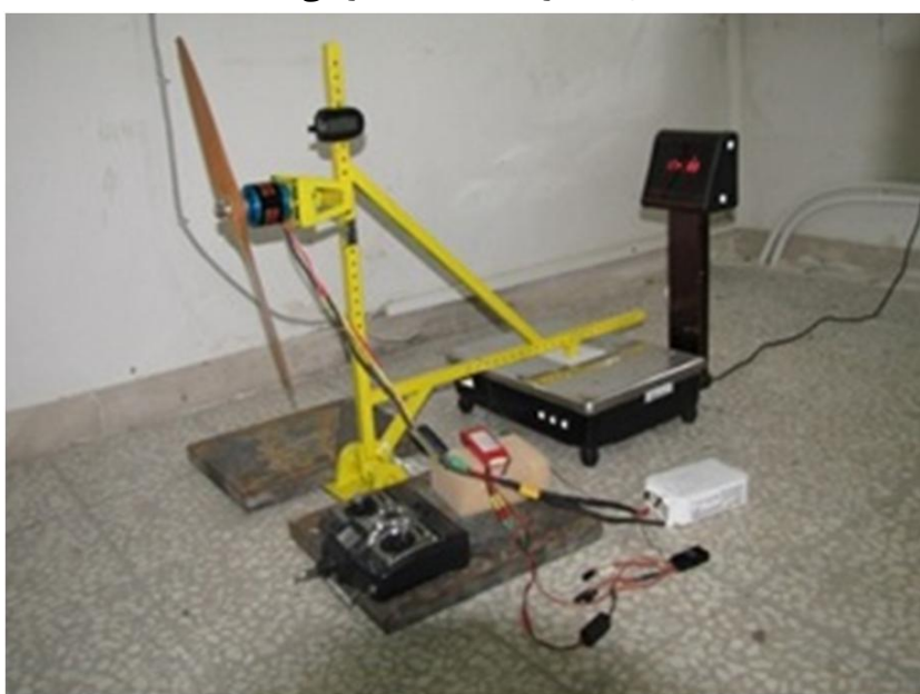
شکل 4 تصویر کلی تست استند به همراه تجهیزات نصب شده به روی آن
