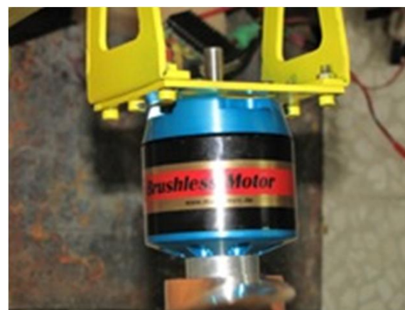
شکل 5 موتور الکتریکی براشلس 2/2 کیلوواتی متعلق به شرکت مولتی پلکس
