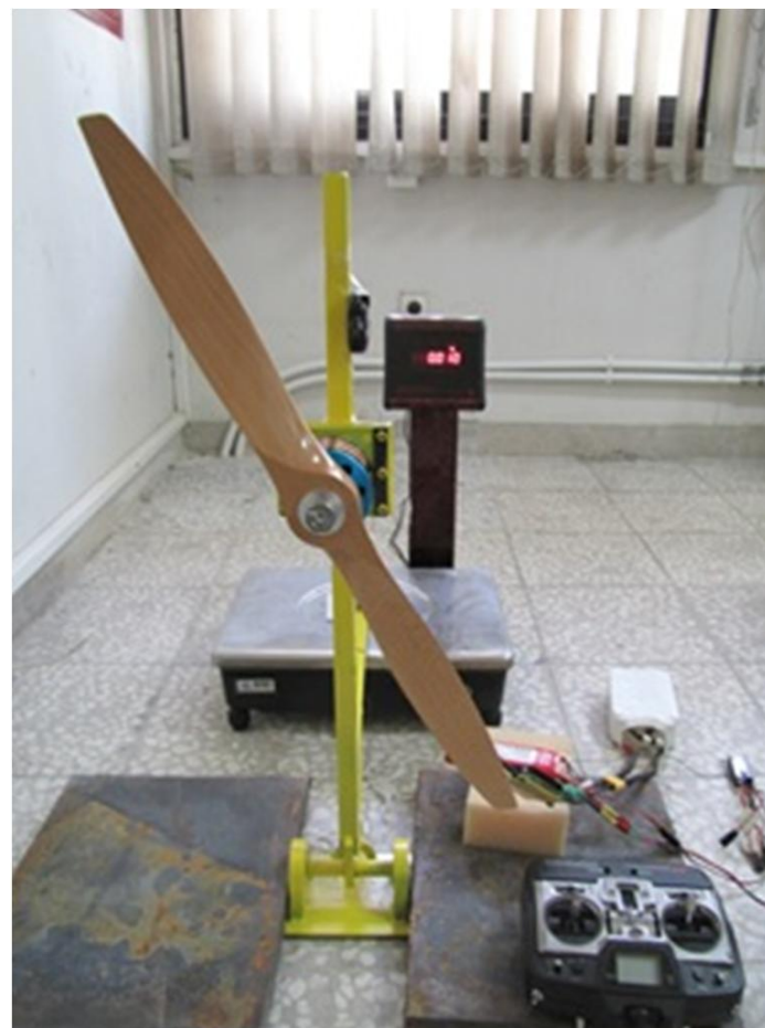
شکل 13 تصویر کلی تست استند به همراه تجهیزات نصب شده به روی آن
