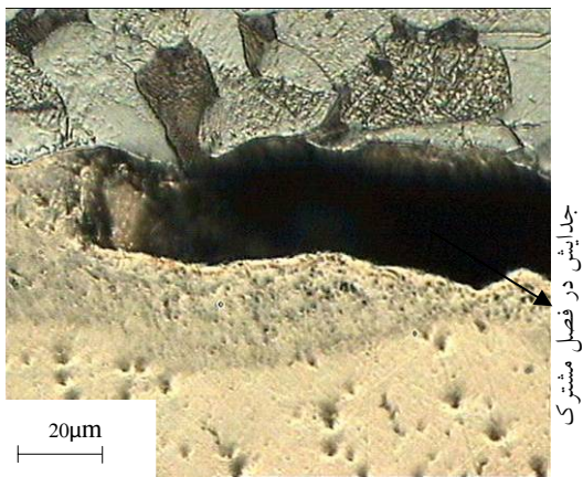
شکل ۱۳ وجود جدایش در فصل مشترک اتصال فولاد و فسفر-
