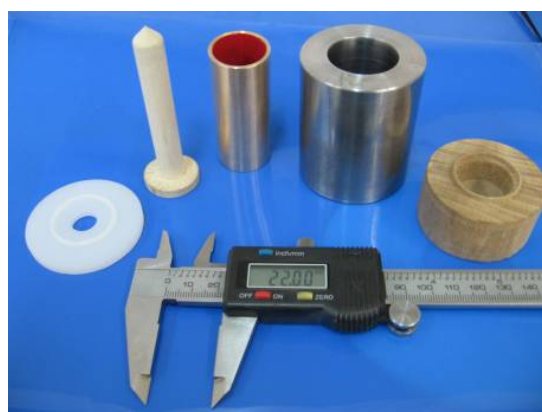
شکل ۵ لوله‌های فولاد St-۳۷ و فسفر برنز همراه با نگهدارنده‌های به کار رفته در آزمایشها [۷]
