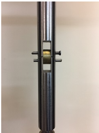
شکل ۲) نمایش تجهیزات مورد استفاده برای اندازه‌گیری خواص مکانیکی در راستای محیطی
