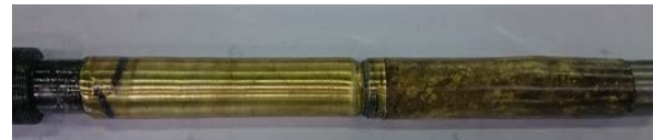
شکل ۳) لوله فرآوری‌شده با فرآیند اصطکاکی تغییر شکل پلاستیک شدید لوله
