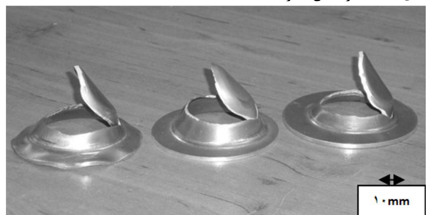
شکل 5 نمونه‌هایی با شعاع گوشه سنبه و شعاع گوشه حفره قالب (mm) به ترتیب از راست به چپ، 4، 4.4 و 4.6 و 4
