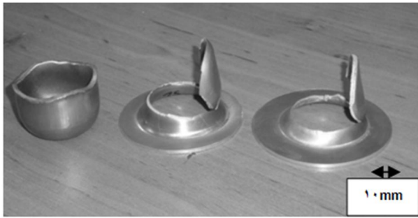
شکل 6 نمونه‌هایی با شعاع گوشه سنبه و شعاع گوشه حفره قالب (mm) به ترتیب از راست به چپ، 8، 8.4 و 8.6 و 8
