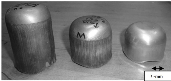
شکل 18 نمونه‌های شکل گرفته در دماهای به ترتیب از راست به چپ: دمای محیط، 150°C، 450°C
