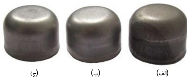
شکل 4 نمونه‌هایی از قطعات شکل داده شده تحت شرایط روانکاری مختلف (الف) حالت خشک (ب) روانکار معمولی و (ج) نانو روانکار
