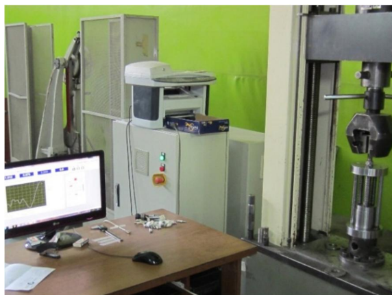
شکل 3 تصویر دستگاه پرس و قالب کشش عمیق مورد استفاده در آزمایشات
