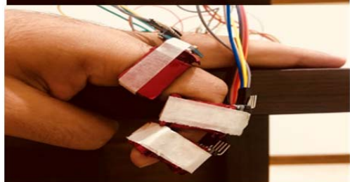
شکل ۵) وضعیت‌های متفاوت انگشت شاخص برای اندازه‌گیری زاویه مفصل توسط وسیله در نظر گرفته شده؛ (الف) موقعیت اولیه انگشت شاخص؛ (ب) موقعیت میانی انگشت شاخص؛ (ج) بیشترین زاویه مفصلی خمشی انگشت شاخص
