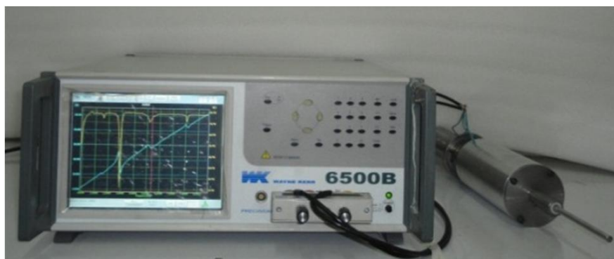
شکل 2 اندازه‌گیری فرکانس رزونانس ترانسدیوسر
