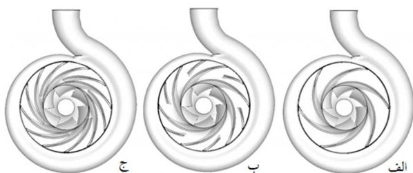
شکل 7 طرح پمپ با پروانه‌های (الف) نوع اول (ب) نوع دوم (ج) نوع سوم
