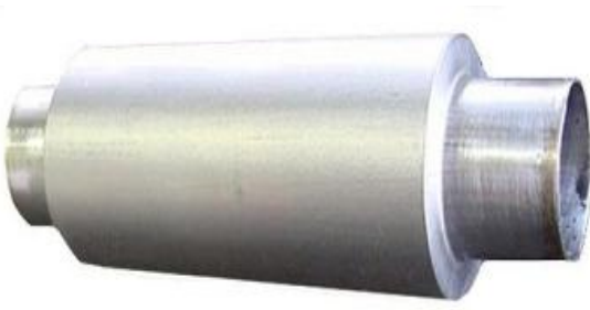
شکل ۱۵ لوله شکل داده شده با روش آزمایشگاهی در قالب جدید هیدروفرمینگ
