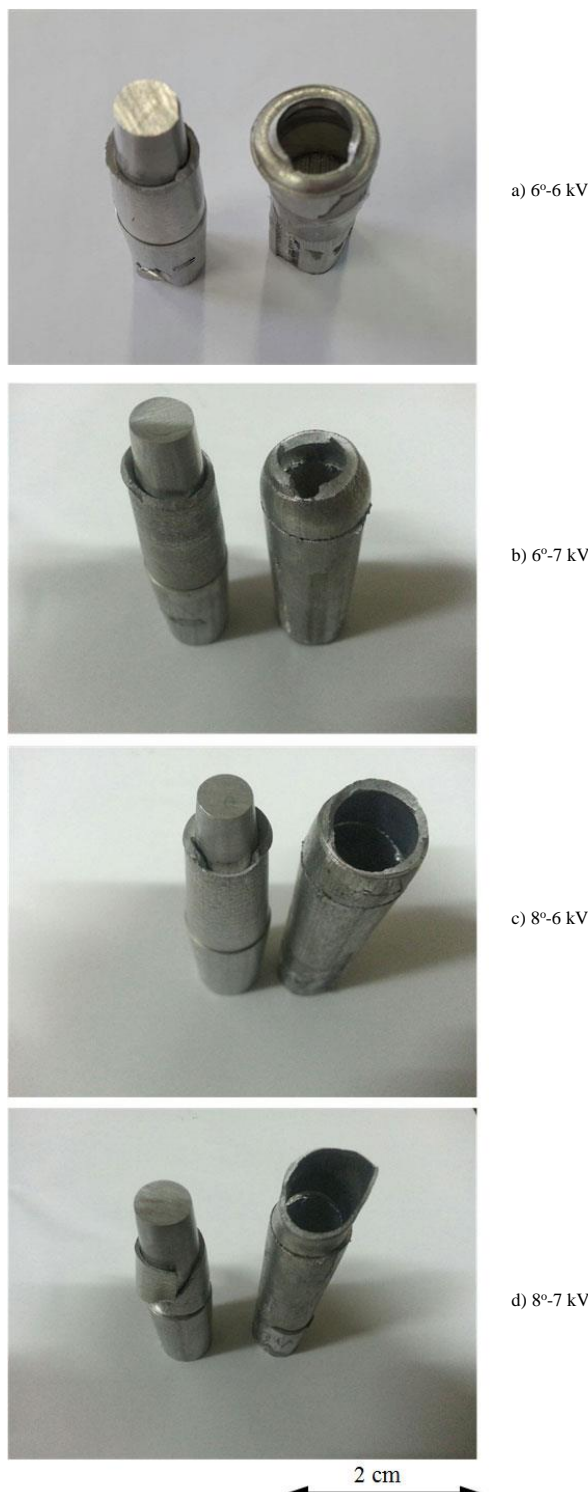
Fig. 12 Macroscopic images of the fracture surface given by the tensile test شکل 12 تصاویر ماکروسکوپی از سطح شکست ایجاد شده توسط آزمون کشش
