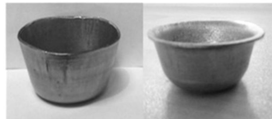
شکل 4 قطعه مخروطی ساخته شده از جنس فولاد St14 الف - فرآیند ساچمه‌ای ب - فرآیند کشش عمیق سنتی
