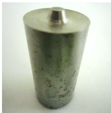
شکل ۳ ابزار HSS حاوی پین مخروطی مورد استفاده در تحقیق
