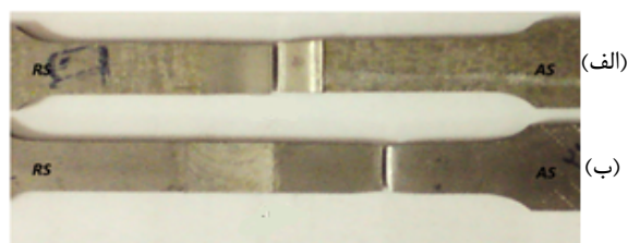
شکل ۹ موقعیت وقوع شکست نمونه‌های جوشکاری شده به روش الف- FSW، ب- UFSW
