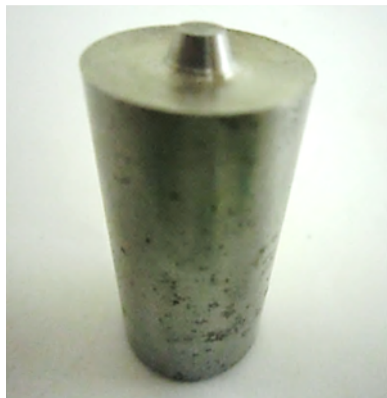
شکل ۳ ابزار HSS حاوی پین مخروطی مورد استفاده در تحقیق
