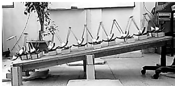
شکل ۲۸ مدل با وزنه‌های ۲۰۰ گرمی اضافه‌شده در انتهای پایین پاها در حال قدمزنی بر روی شیب مبنا
