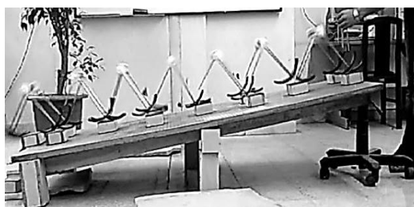
شکل ۲۷ مدل با دو وزنه ۲۰۰ گرمی اضافه شده در بالاتنه در حال قدمزنی بر روی شیب مبنا
