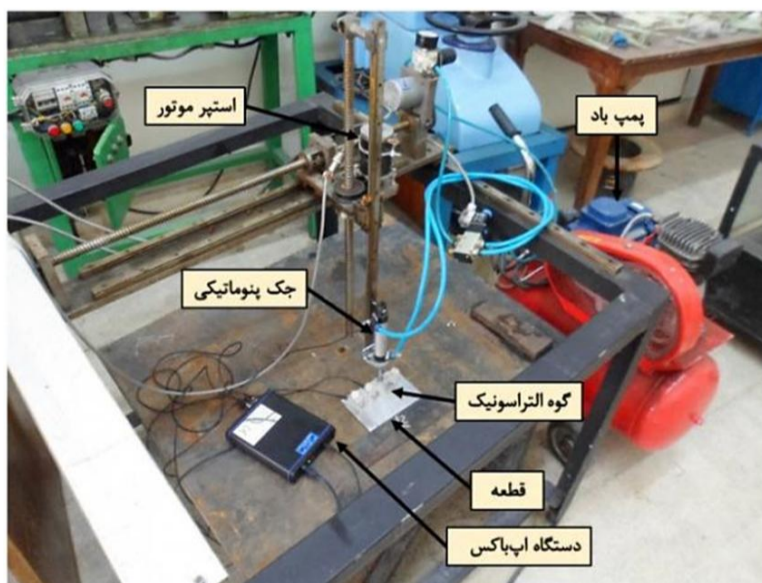
شکل 6 تجهیزات مورد استفاده در روش ترانسونیک
