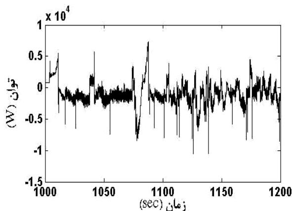
شکل ۱۷ توان وارد بر باتری خودروی هیبرید برقی بدون به کارگیری ابرخازن
