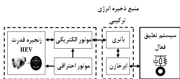
شکل ۲ به کارگیری سیستم تعليق فعال در خودروی هیبرید بر قی
