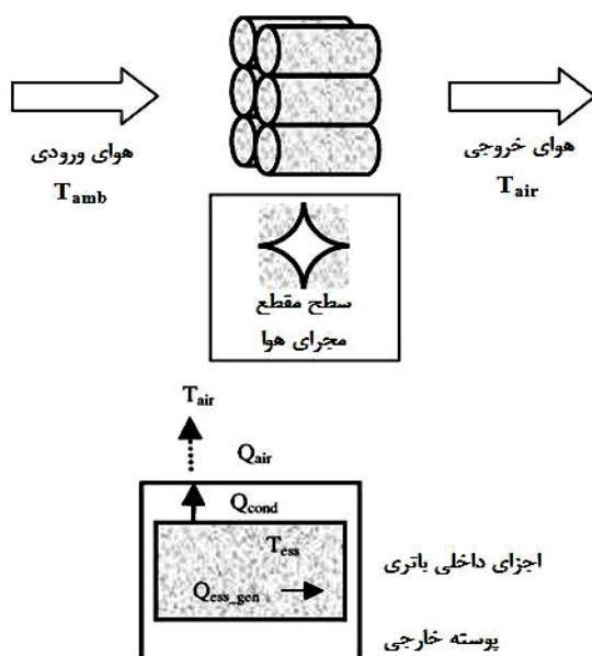
شکل ۱۰ مدل حرارتی ظرفیت متمرکز باتری [۱۷]
